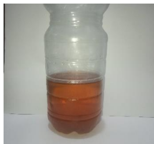
a). Minyak jelantah sebelum dibleaching b). Minyak jelantah sesudah dibleaching Gambar 2. Minyak Jelantah Sebelum dan Sesudah di Bleaching Menggunakan Arang Aktif
