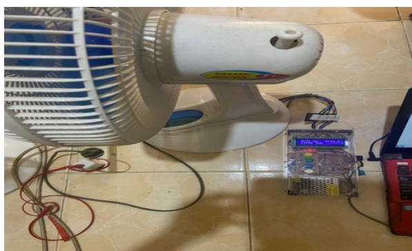
Gambar 7. Kipas Angin Menyala Ketika Suhu Di atas 32 o C
