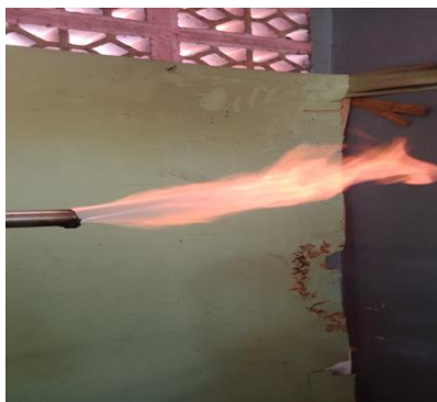
Gambar Flare test dari gasifikasi campuran serbuk kayu dan pellet kayu
