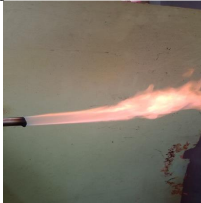
Gambar flare test dari gasifikasi pellet kayu
