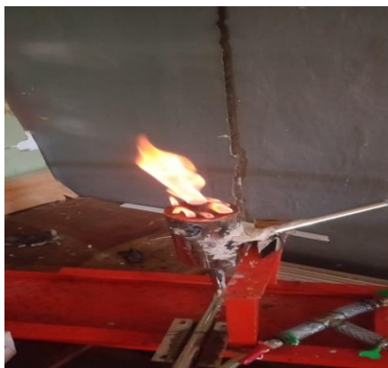
Gambar Flare test dari gasifikasi campuran pellet sampah pasar dan pellet kayu 1:1
