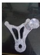
Gambar 1. Hasil coran caliper bracket sebelum finishing
