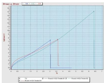
Gambar 5. Grafik Tensile Test Report ATSM E 8
