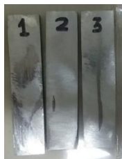
(Spesimen caliper bracket standar) (Spesimen Caliper Bracket Casting ) Gambar 4. Spesimen caliper bracket sebelum pengujian tarik
