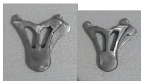
Gambar 2. Hasil Coran caliper bracket Setelah Finishing
