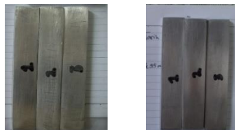
( Spesimen Produk Casting ) ( Spesimen Produk standar ) gambar 3. Spesimen Caliper Bracket Pengujian Tari
