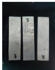
(Spesimen caliper bracket standar) (Spesimen Caliper Bracket Casting ) Gambar 4. Spesimen caliper bracket sebelum pengujian tarik
