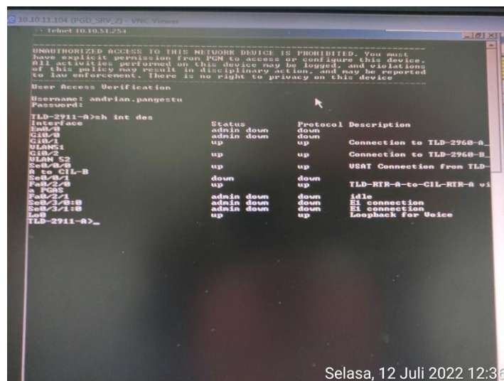
Gambar 2 Konfigurasi Interface Router
