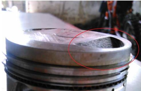
**Gambar 2. Coakan Klep Pada Piston**
