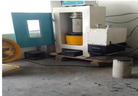
**Gambar.3. Proses Pengujian Beton**
