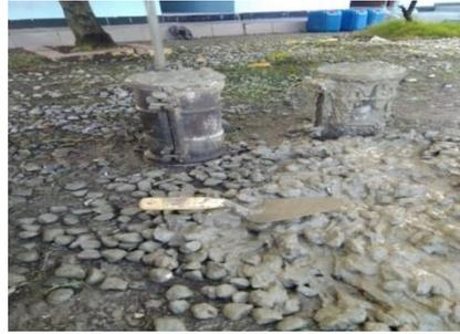
**Gambar.2. Proses Pembuatan Sampel Beton**
