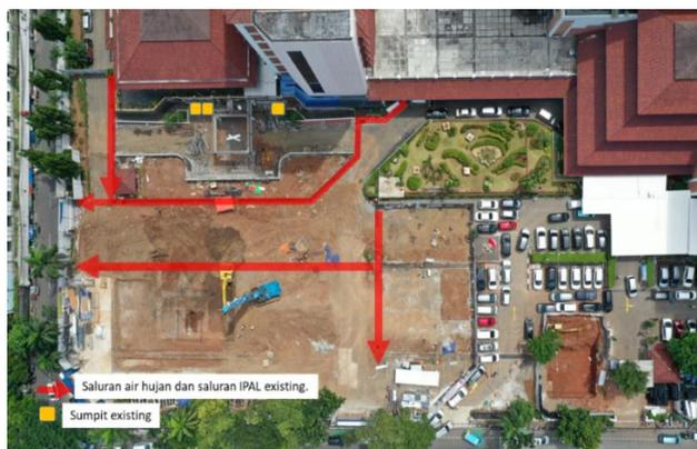
**Gambar 7. Survey Saluran Beton Bertulang Eksisting sebelum Pembongkaran Dilakukan**
