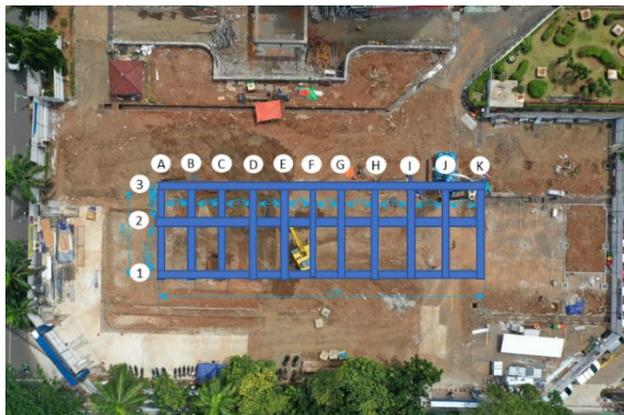
**Gambar 6. Survey Pondasi Beton Bertulang Eksisting sebelum Pembongkaran Dilakukan**
