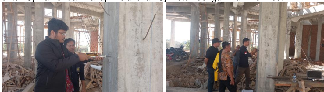
Gambar 3. Pembuatan garis Uji dan pengujian hammer Test
