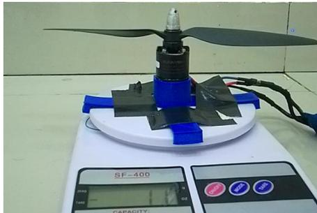
**Gambar 6 Pengujian Motor Brushless**
