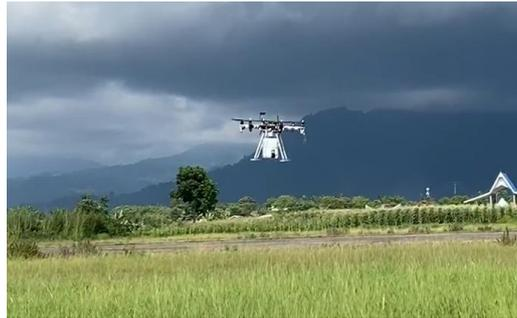
Gambar 8. Pengujian daya angkat drone
