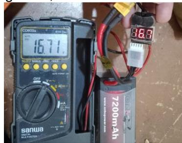
**Gambar 5 Pengukuran Tegangan Baterai**
