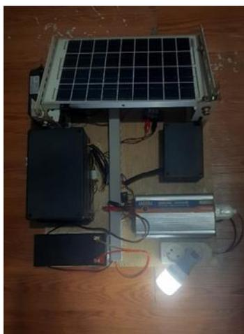
**Gambar 18. Pengujian Menggunakan Beban Lampu 5 Watt**
