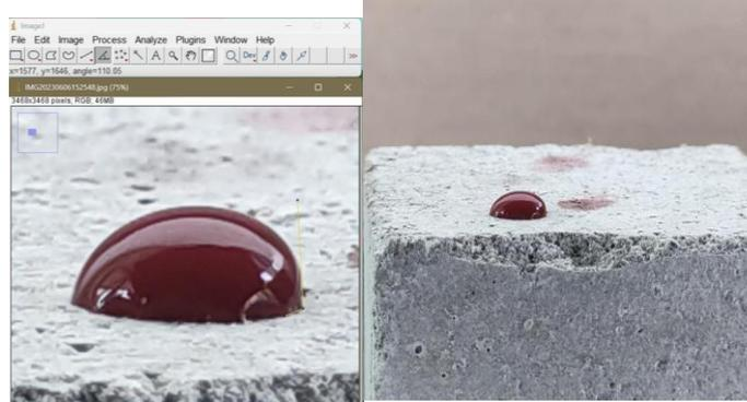
Berdasarkan gambar 5 beton diberikan tetesan air untuk mengetahui sudut kontakannya. Lalu difoto menggunakan kamera, hasil
