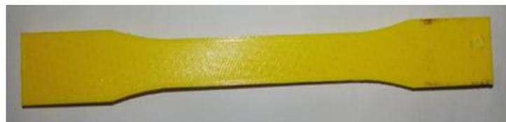
**Gambar 3. Hasil Pencetakan Spesimen.**
