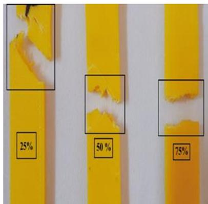
**Gambar 5. Patahan spesimen uji tarik**
