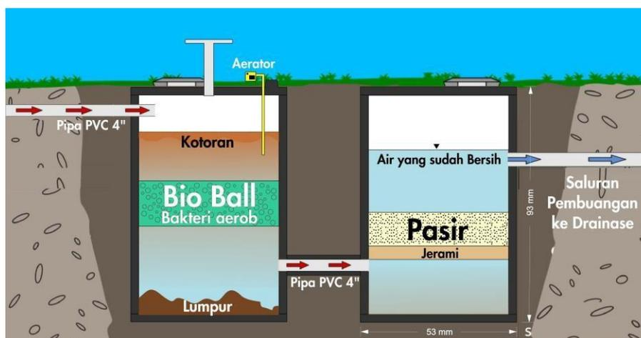
**Gambar 3. Ilustrasi tangki bio-porta di dalam tanah.**
