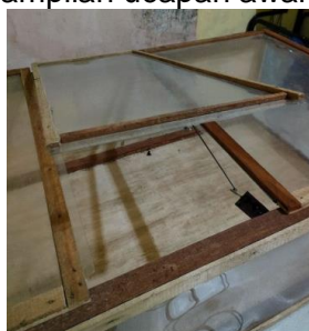
Gambar 20. Ventilasi alat terbuka untuk mengeluarkan hawa panas dan menyejukkan ruangan
