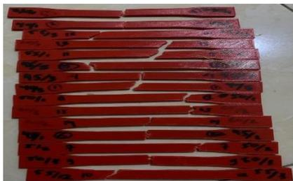
**Gambar 1. Patahan pengujian Tensile Strength**
