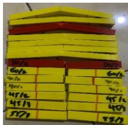
**Gambar 3 Patahan pengujian Bending Strength**
