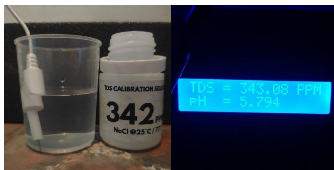
Gambar 7. Hasil Pembacaan Sensor TDS
