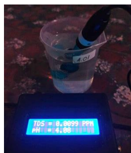
Gambar 5. Hasil Pembacaan Sensor pH (4,01)
