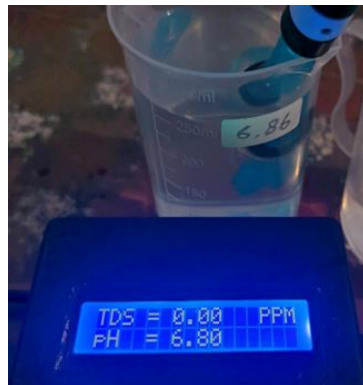
Gambar 6. Hasil Pembacaan Sensor pH (6,86)
