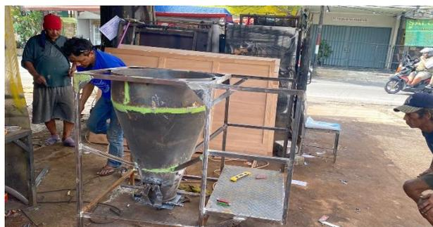
**Gambar 4. Proses Pembuatan Prototipe *Bucket* Cor**
