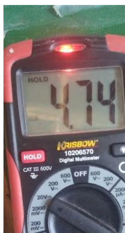
Gambar 19. pengukuran tegangan dalam kondisi diam
