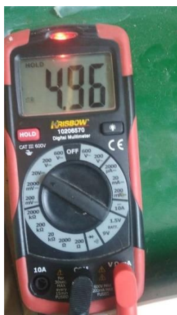
Gambar 16. Pengukuran Tegangan loadcell hx711 membaca berat ikan
