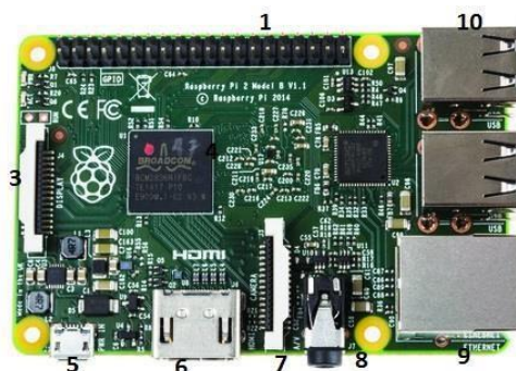
Gambar 4. Arsitektur Raspberry Pi Model B
