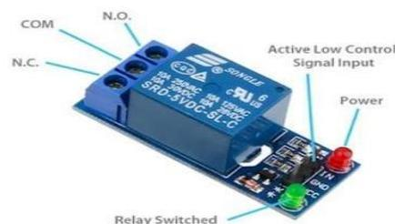
Gambar 6. Skematik Relay Module
