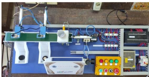
**Gambar 4. Hasil pembuatan trainer mini 4402ndustry (shorting machine) berbasis PLC OMRON**
