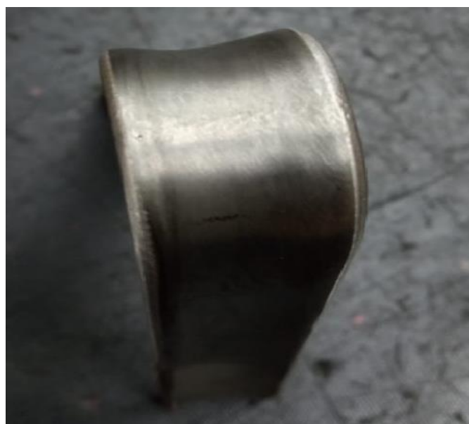
Gambar 8. Spesimen hasil uji transverse root bend yang terindikasi diskontinuitas terbuka
