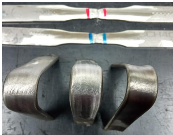
Gambar 7: Spesimen hasil uji transverse face bend ( kiri dan tengah) dan transverse root bend ( kanan)
