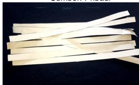
Gambar 4. Kertas duplek yang sudah dipotong menjadi bilah kertas sebagai bahan utama pembuatan canting cap
